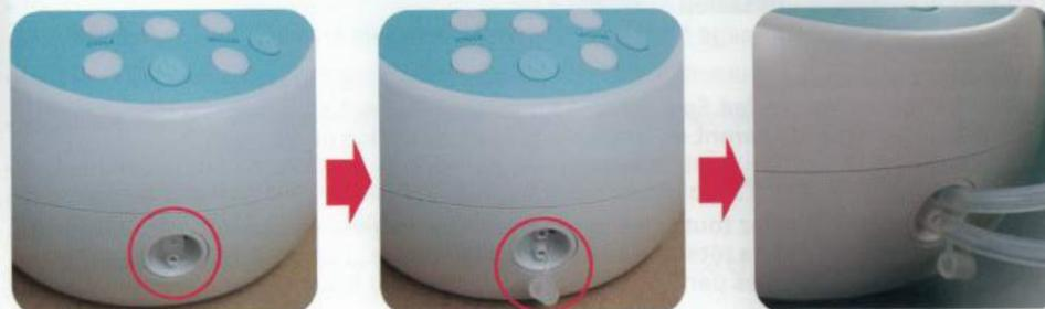
1) Retirez le bouchon sur le deuxième connecteur d'air
